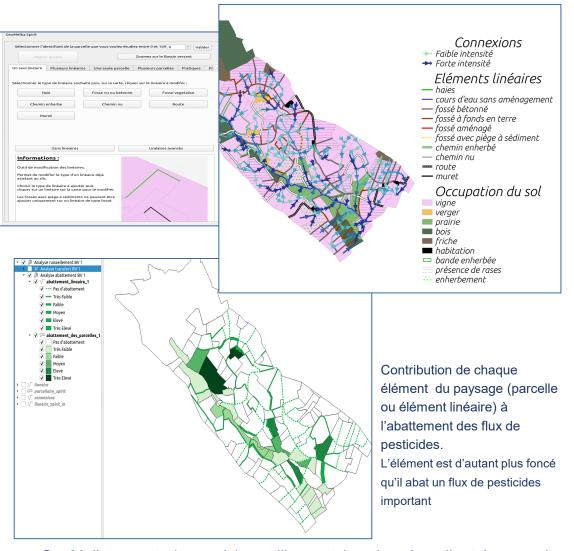
GeoMelba construit aussi le maillage et les données d'entrée pour le **modèle dynamique PeshMelba** (Pesticides et Hydrologie : Modélisation à l'echelle du Bassin versant) développé au sein d'INRAE.
